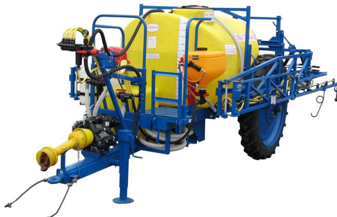
Рис. 3.1. Загальний вигляд обприскувача ОП-2500-18.
