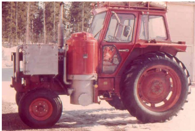
Рис. 2. Газогенераторний трактор фірми Volvo, який працює на пелетованих рослинних відходах
