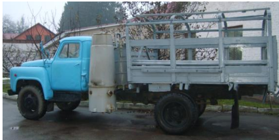
Рис. 5. Газогенераторний автомобіль, розроблений у ЖНАЕУ
