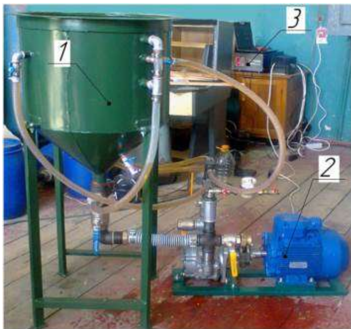
Рис. 17. Комплект обладнання для дослідної перевірки енергетичної ефективності виробництва дизельного біопалива у циркуляційних змішувачах:
