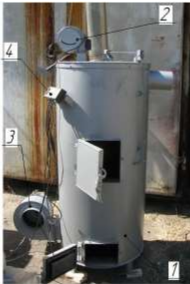
Рис. 1. Дослідна установка для встановлення енергетичної ефективності котлів із верхнім горінням:
