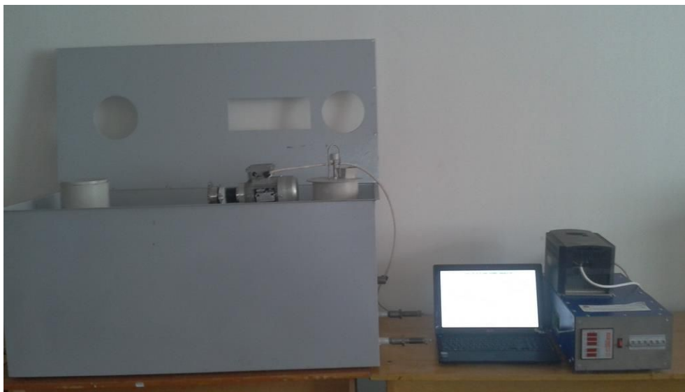
Рис. 2. Обертовий метантенк встановлено у зовнішній корпус.
