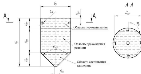
Рис. 1. Расчетная схема гравитационного разделителя: H_p – высота разделителя, м; H_{оп} – высота области перемешивания, м; H_{пр} – высота области прохождения реакции, м; H_{вг} – высота области отстаивания глицерина, м; D_p – рабочий диаметр разделителя, м; D_{вф} – диаметр установки форсунок, м; d_{ф} – диаметр сопла форсунки, м; h_{вф} – высота установки форсунок, м; D_{зл} – диаметр отверстия для слива глицерина, м; \alpha_{об} – конусность области отстаивания, рад; \alpha_{ф} – угол установки форсунки, рад
