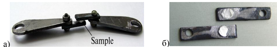
Рис.9. Схема кріплення зразків до захватів при випробовуванні на зріз а) до випробування; б) після випробування
