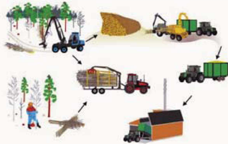
Рис. 8. Схема процесса заготовки щепы
