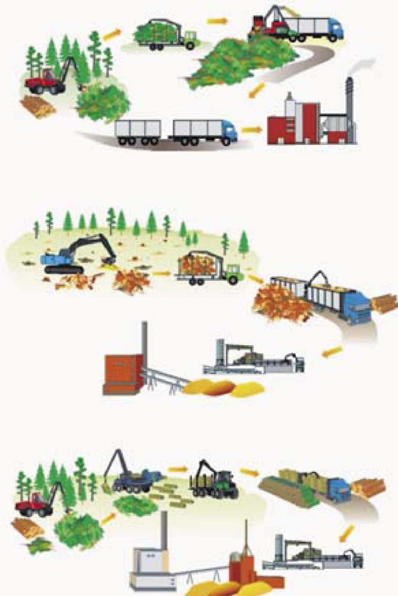
Рис. 7. Оптимизированная структура процесса заготовки щепы
