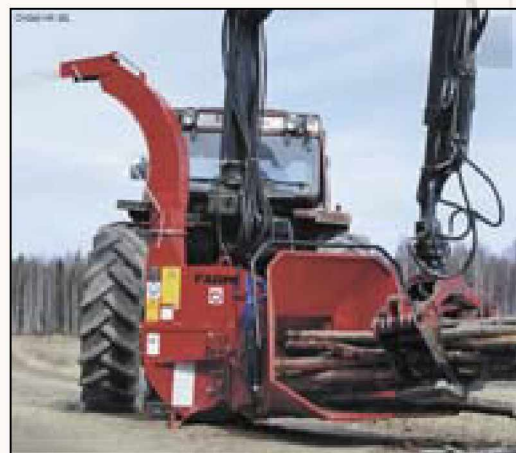
Современная мобильная рубительная установка CH260 HF-2EL (Финляндия)
