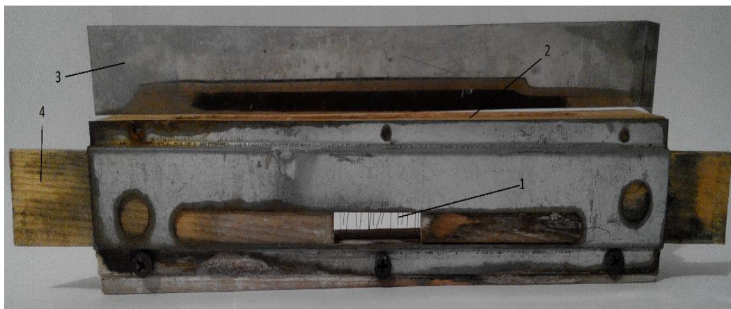
Рис. 1 Спеціальний пристрій з лункою (поглибленням) для органічних кислот, що просочуються через кінські волоски, вмонтовані в дно
