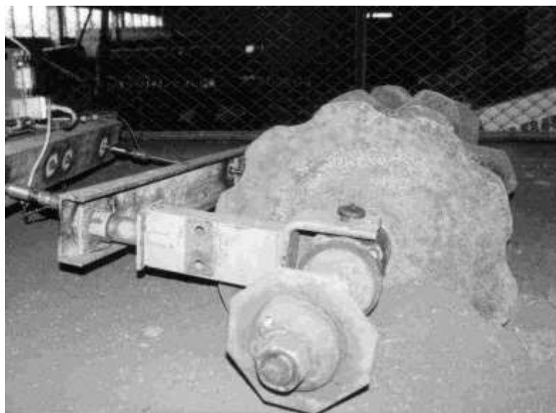
Рис.4.9. Визначення тягового опору стандартного робочого органу відповідного до [84]
