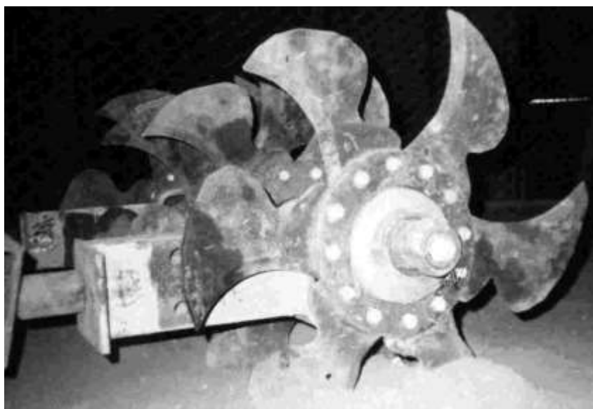
Рис.4.10. Визначення тягового опору ротаційно-лопатевого робочого органу
