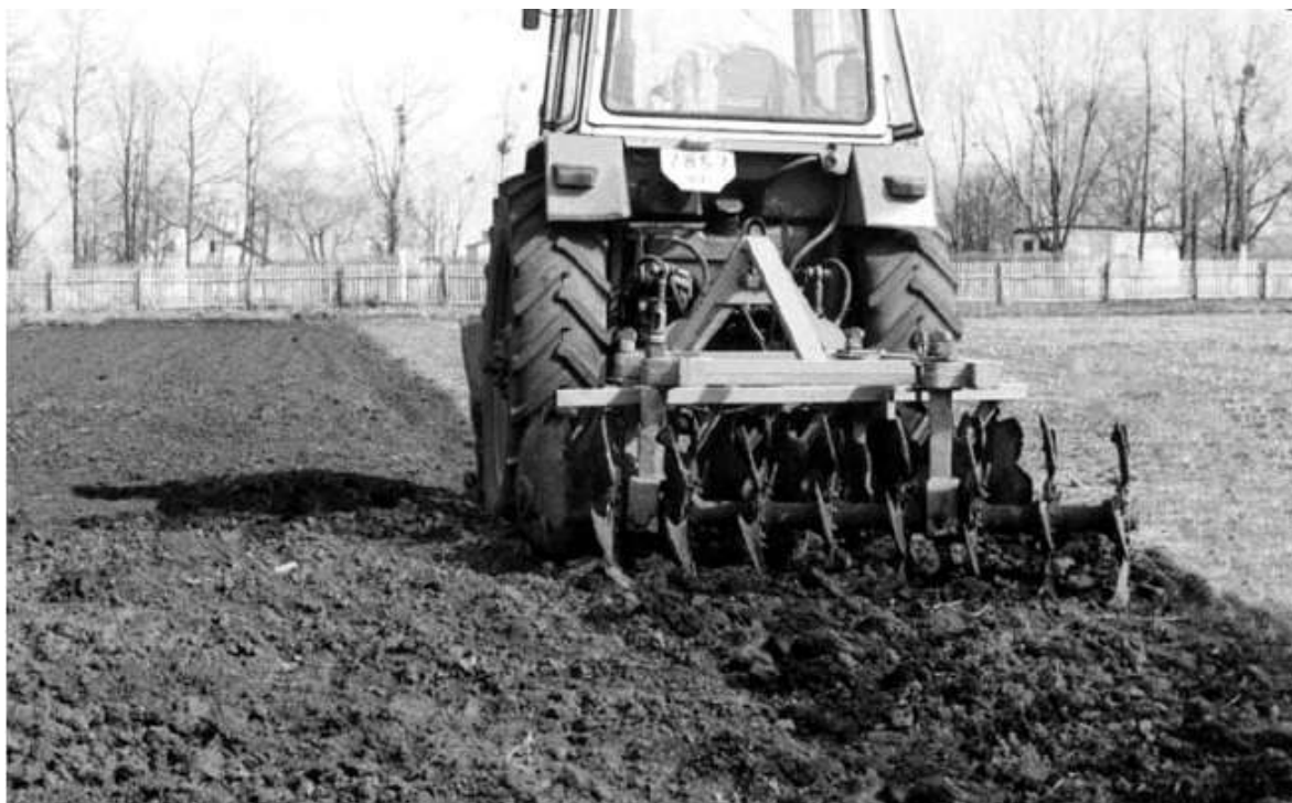
Рис.4.16. Характер обробітку ґрунтообробним агрегатом у складі ПМЗ– БАЛ+БДН-1,8РЛ-1 (заднє розміщення пропонованих робочих органів)
