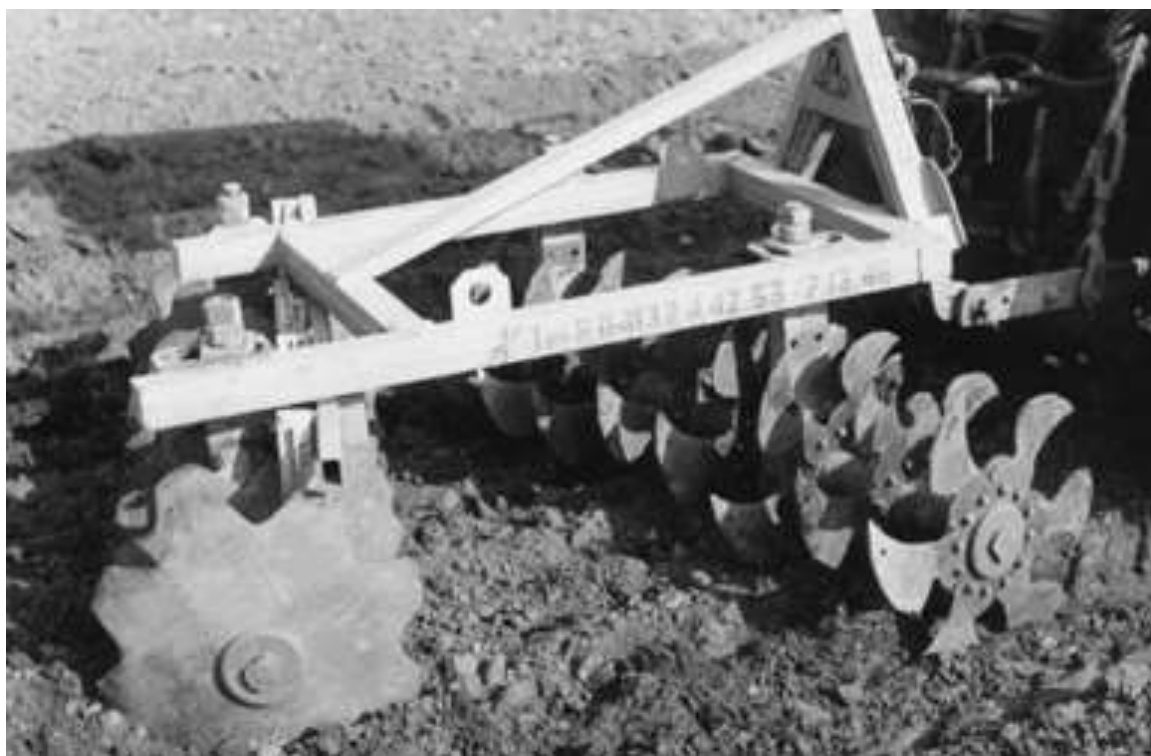
Рис.4.17 – Характер обробітку ґрунтообробним агрегатом у складі ПМЗ– БАЛ+БДН-1,8РЛ-2 (переднє розміщення пропонованих робочих органів)
