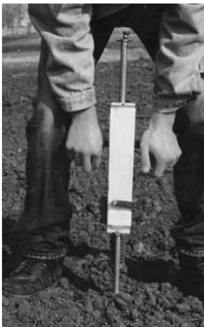
Рис.3.13 Визначення твердості ґрунту за допомогою твердоміру
