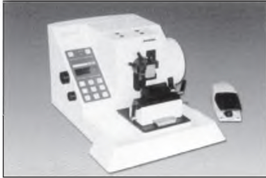
Рис.5. Ротаційний мікромом „НМ 360” з автоматичним приводом і системою подачі зрізів. Забезпечений програмними режимами для виготовлення та вирівнювання зрізів (товщина зрізів 0,25—60 мкм ).
