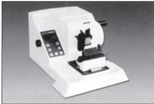
Рис.4. Ротаційний мікромом „НМ 340 Е” з електромеханічною системою подачі зразка матеріалу та ручним ріжучим приводом. Має три швидкості подачі матеріалу. Товщина зрізів 0,5–100 мкм.
