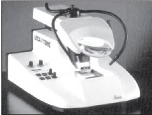
Рис. 7. Вібраційний лезовий мікромом „Leica VT 1000 S”.
