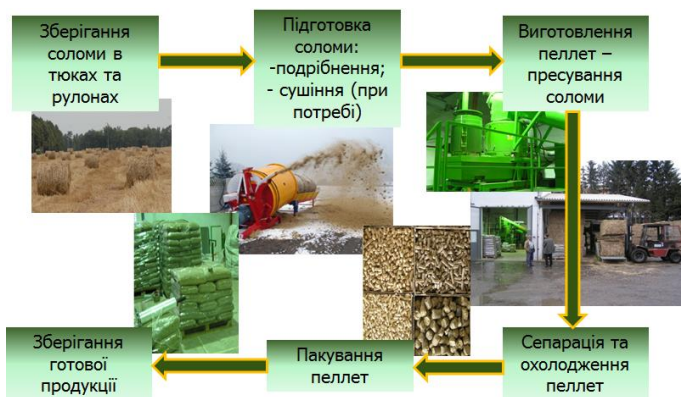
Рис. 6. Технологічний процес виготовлення пеллет з соломи
