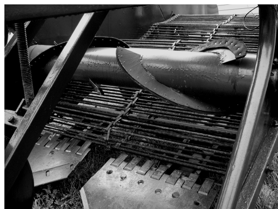
Рис. 5. Розрихлювач-вирівнювач комбінованого сепаратора
