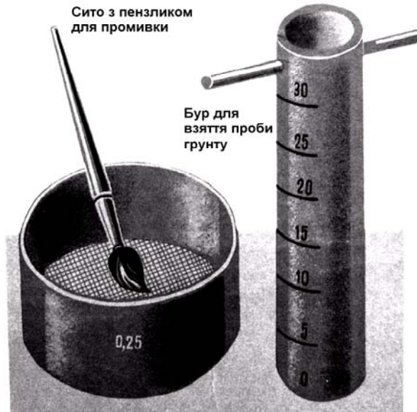
Мал. 4.9. Прилади для обліку засміченості ґрунту насінням бур'янів
