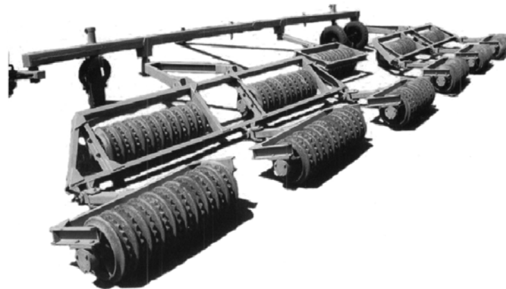
Мал. 4.53. Коток-подрібнювач зубовий КПЗ-10
