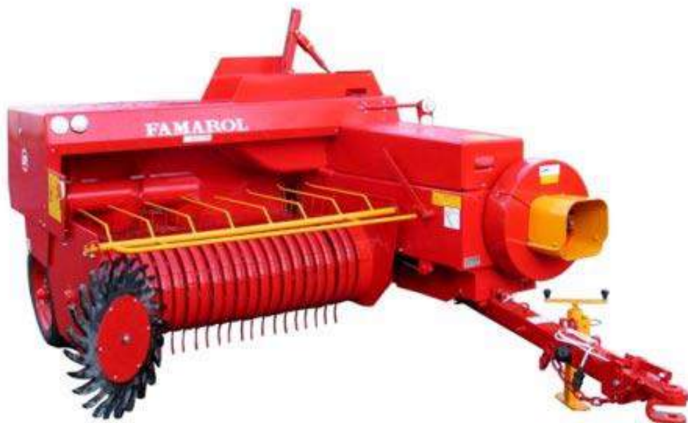
Рис.3. Загальний вигляд прес-підбирача поршневого типу для формування малогабаритних тюків, марки FAMAROL Z-511
