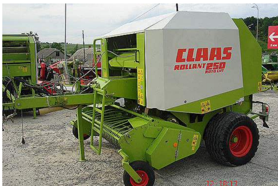
Рис.4. Загальний вигляд прес-підбирача рулонного типу для формування тюків середнього та великого типорозмірів, марки Ролант 250.
