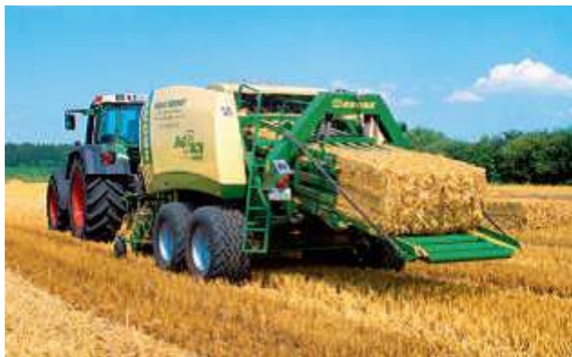
Рис.5. Загальний вигляд прес-підбирача поршневого типу для формування тюків середнього та великого типорозмірів, марки Krone "BigPack VFS1290"
