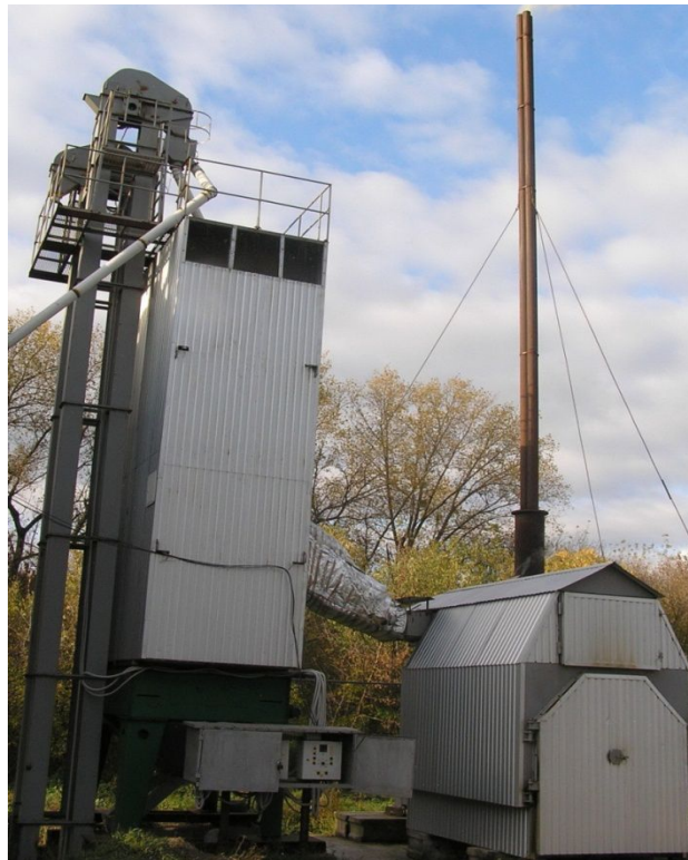
Рис. 17. Зерносушарка з теплогенератором ТГС-500 у навчально-дослідному господарстві НУБіП України «Агрономічна дослідна станція»
