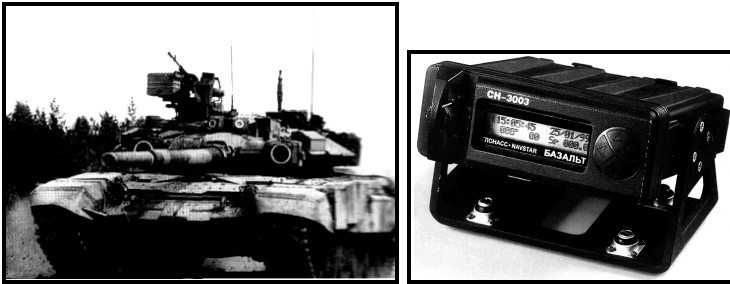
Рис. 4.8. Навігаційний приймач СН-3003 для жорстких умов експлуатації
