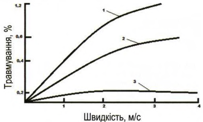
Рис. 4 – Пошкодження пшениці на різних швидкостях руху стрічки: 1 – 3,8 м/с; 2 – 2,1 м/с; 3 – 0,5 м/с.
