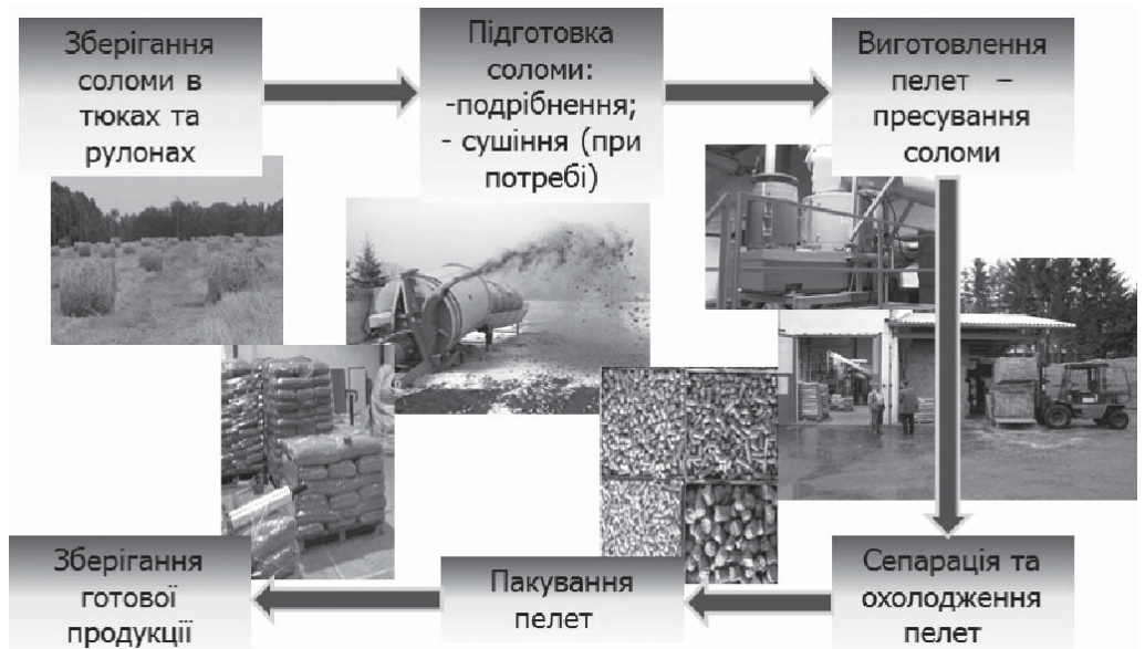
Рис. 1. Технологічний процес виготовлення пелет з соломи
