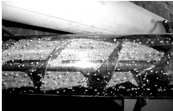
Рисунок 5 - Дослідження руху зернового матеріалу при n більше 150 \text{ хв}^{-1}
