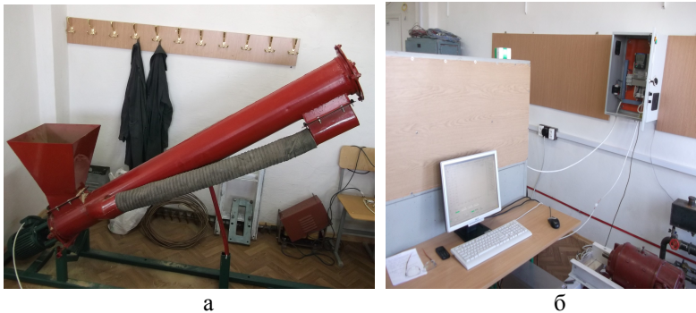
Рис. 5 - Загальний вигляд дослідної установки: а – гвинтового змішувача з пересипом; б – експериментальна апаратура
