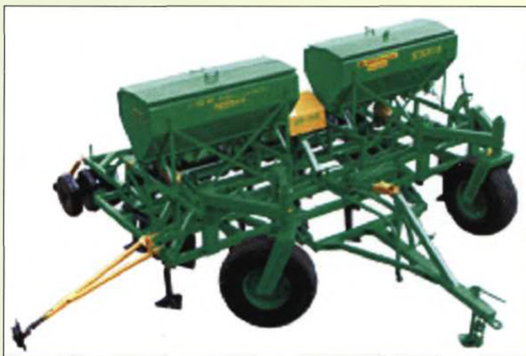
Фото 1. Агрегат універсальний посівний плоскорізальний АУП-18.05
