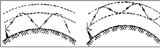
Рис.2.16. Розповсюдження радіохвиль уздовж шарових неоднорідностей
