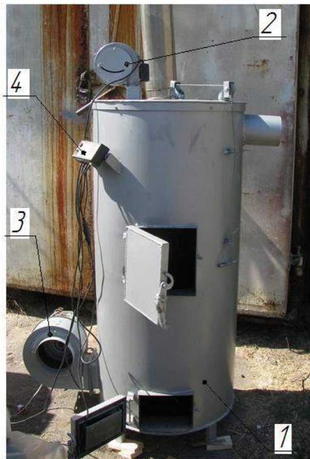
Рис. 3.3. Дослідна установка для встановлення енергетичної ефективності спалювання соломи зернових у котлах із верхнім горінням:
