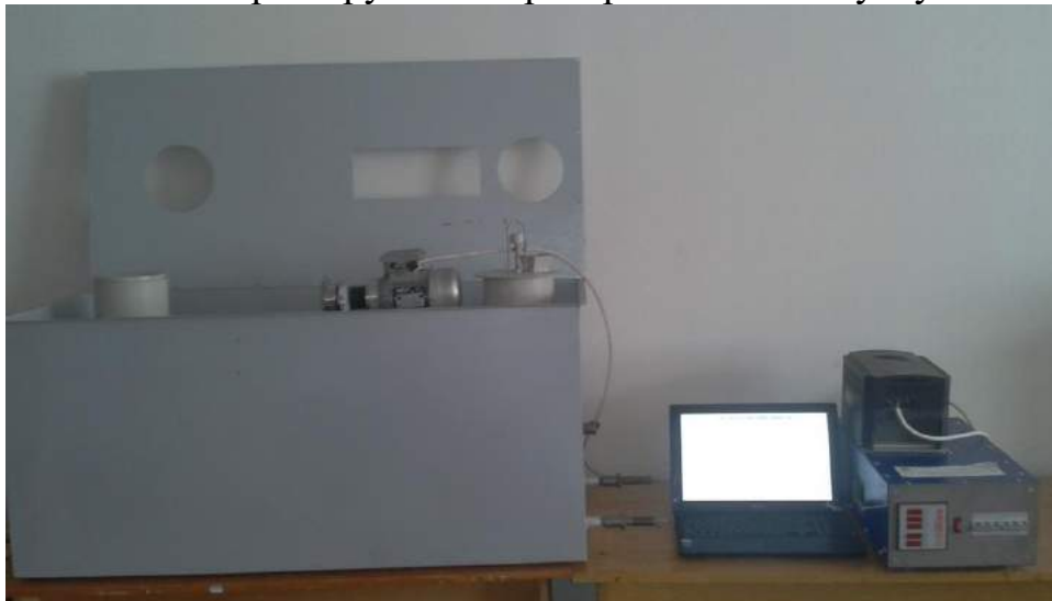
Рис. 3.2. Обертовий метантенк встановлено у зовнішній корпус
