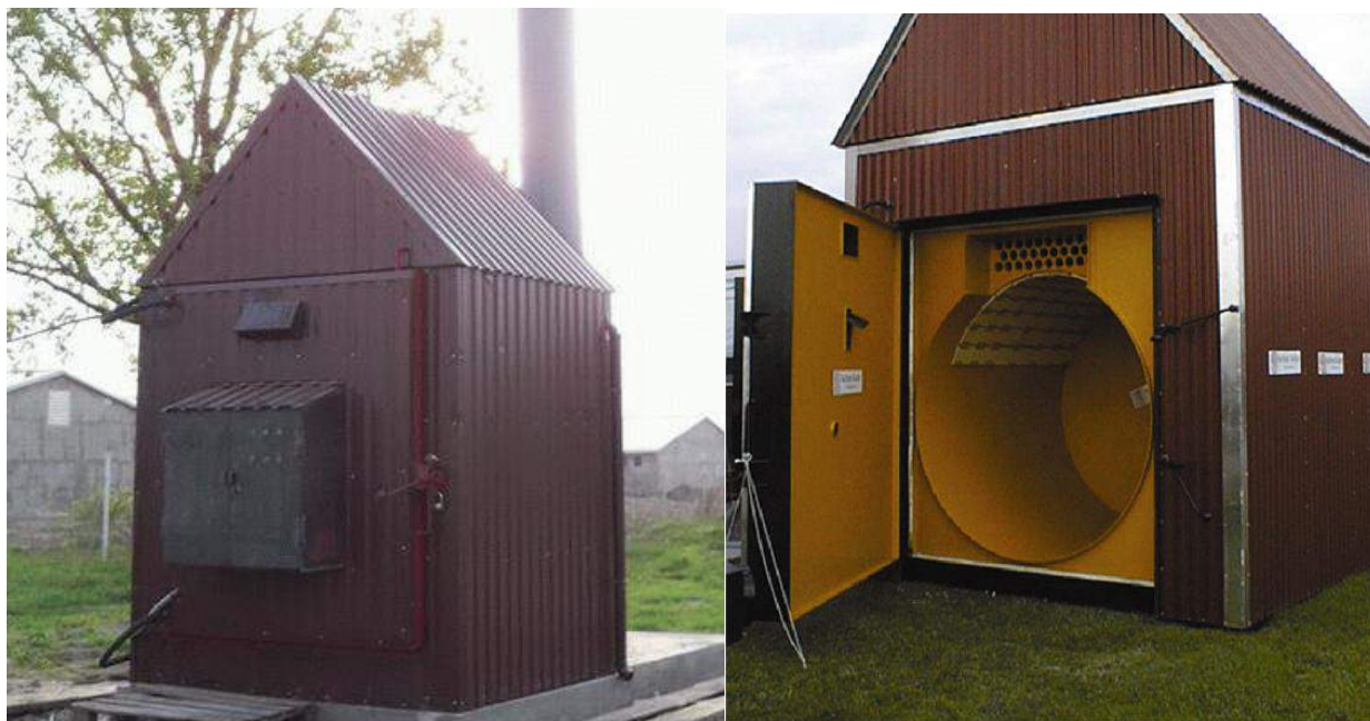
Рис. 1.7. Котел RAU-2-600 для отримання теплової енергії від спалювання соломи виробництва АТ "Південтеплоенергомонтаж"
