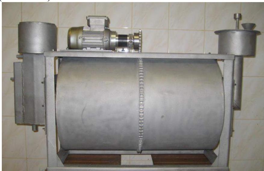
Рис. 4.6. Біогазовий реактор БОР-0,4 (зовнішній корпус знято)
