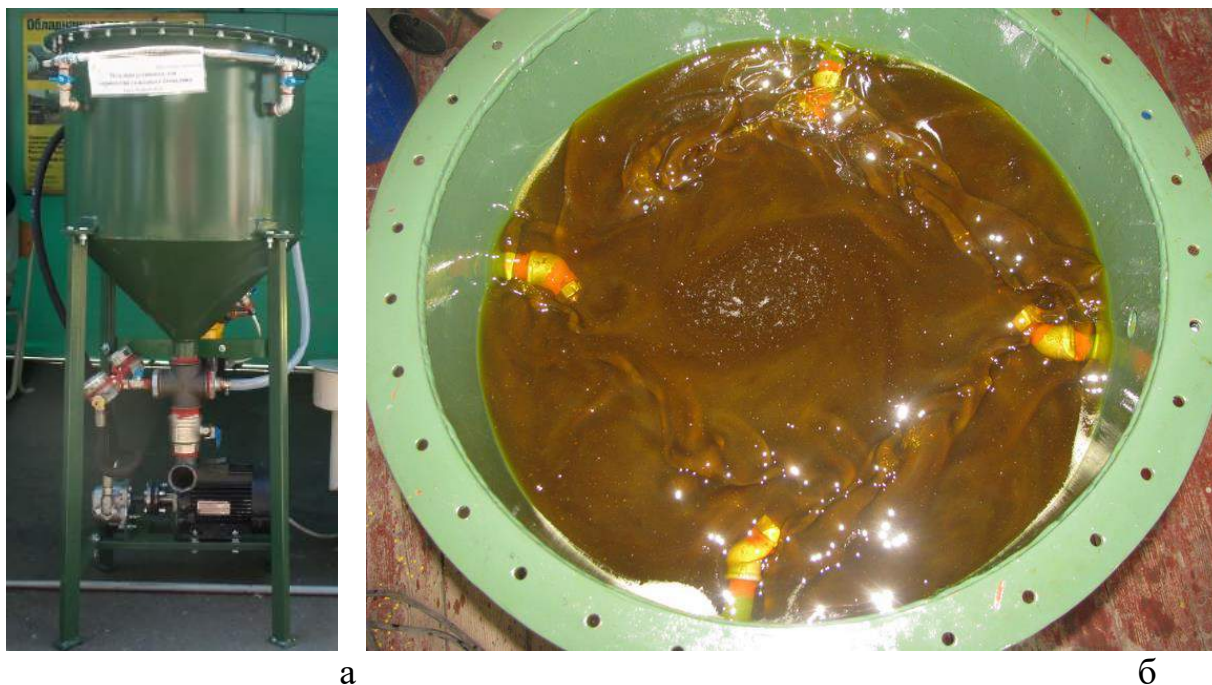
Рис. 4.18. Зовнішній вигляд (а) та процес роботи (б) циркуляційного реактора змішувача-розділювача для отримання дизельного біопалива ЦРПР-2
