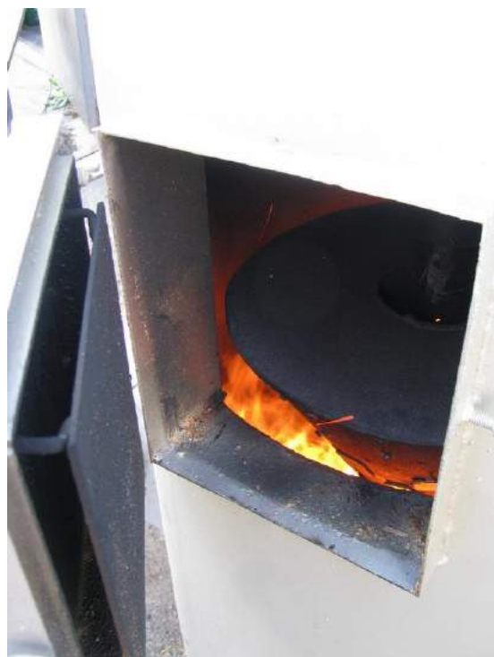
Рис. 4.10. Котел КГВ-20 (а) із верхнім горінням для спалювання соломи-січки ( P_k=20 кВт) та його розподільник повітря (б)
