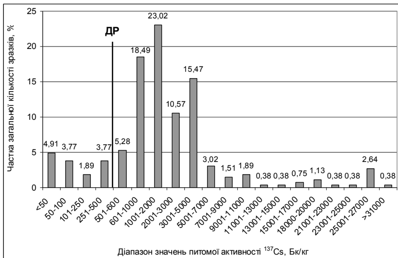
Рис. 5. Гістограма розподілу значень питомої активності ^{137}\text{Cs} у зразках дикорослої рослинної лікарської сировини з допустимим вмістом ^{137}\text{Cs} 500 Бк/кг
