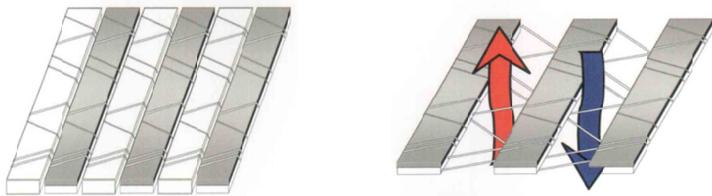
Рис. 1. Структура матерії шторного екрану та схема циркуляції повітря
