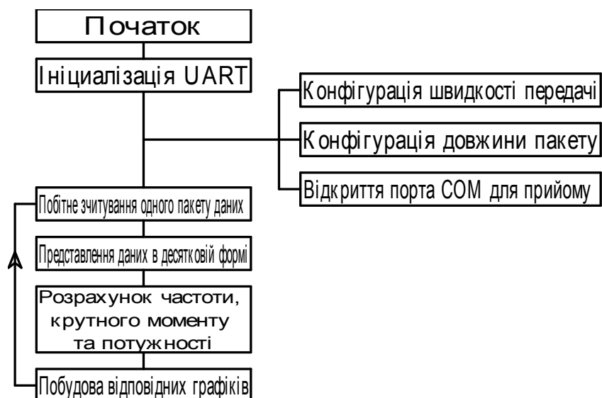
Рис. 9. Загальний алгоритм роботи програми «DTW»
