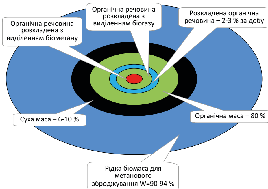
Рис. 8 Схематичне зображення виходу біометану та біогазу із розкладеної органічної маси
