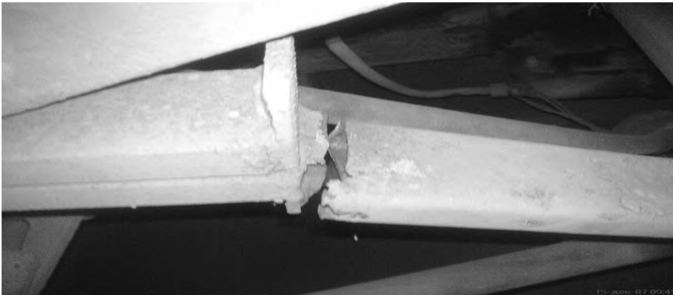
Рис. 2. Тріщини в горизонтальній частині об'ємного каркаса автобуса ЛАЗ-695НГ
