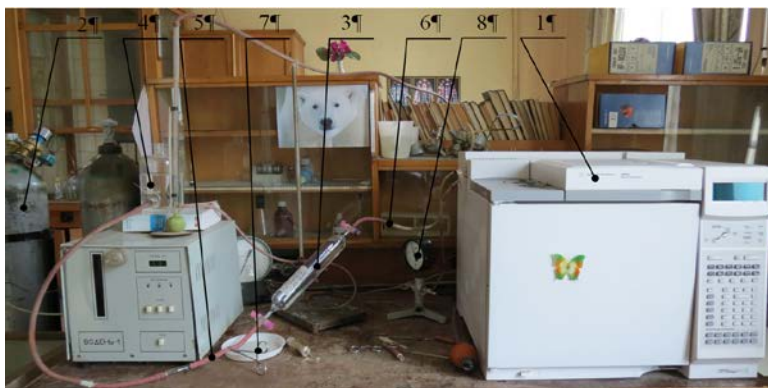
Рис. 1. Схема експериментальної установки для визначення складу генераторного газу: 1 – двоканальний хроматограф мод. Agilent 6890 N; 2 – балон з газом-носієм (аргоном); 3 – скляна піпетка на 500 мл з досліджуванним газом; 4 – ємність з насиченим водним розчином повареної солі; 5 – гумовий рукав для підведення водного розчину; 6 – гумовий рукав для введення проби газу у випарувувач хроматографа; 7 – затискач; 8 – манометр.
