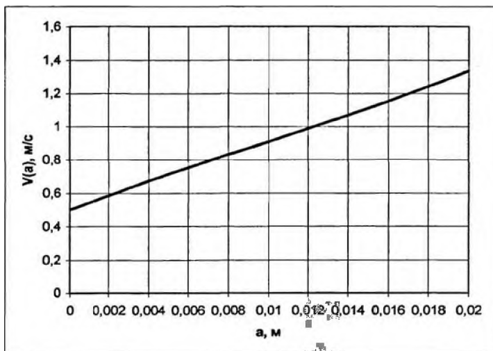
Рис. 5. Теоретична залежність швидкості руху насіння від координати потрапляння насіння на криволінійну поверхню розподільника
