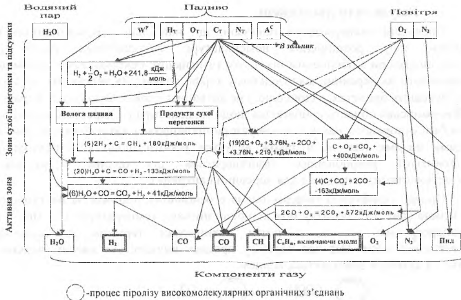
Рис. 2. Процеси газифікації палива, які протікають в газогенераторі
