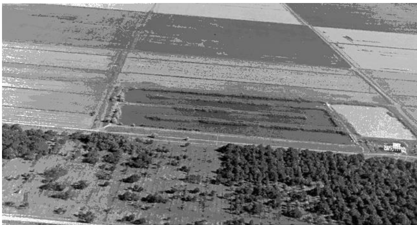
Рис. 5.12. Закрита чекова зрошувальна система конструкції В.Й. Маковського в Скадовському районі Херсонської області
