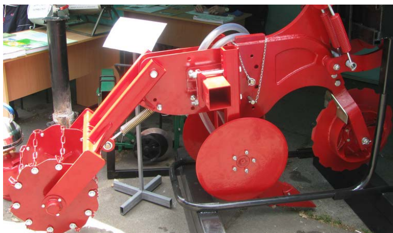
Рис. 4. Секція ґрунтообробного знаряддя для смугової обробки ґрунту
