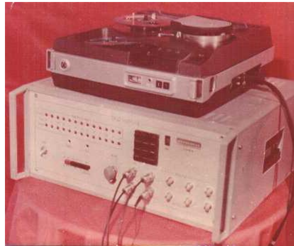
Рис. 15. Фібоначчів реєстратор вимірювальних сигналів
