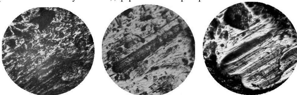
Рис. 3. Зношена поверхня матеріалу решіт ( \times 100 )
