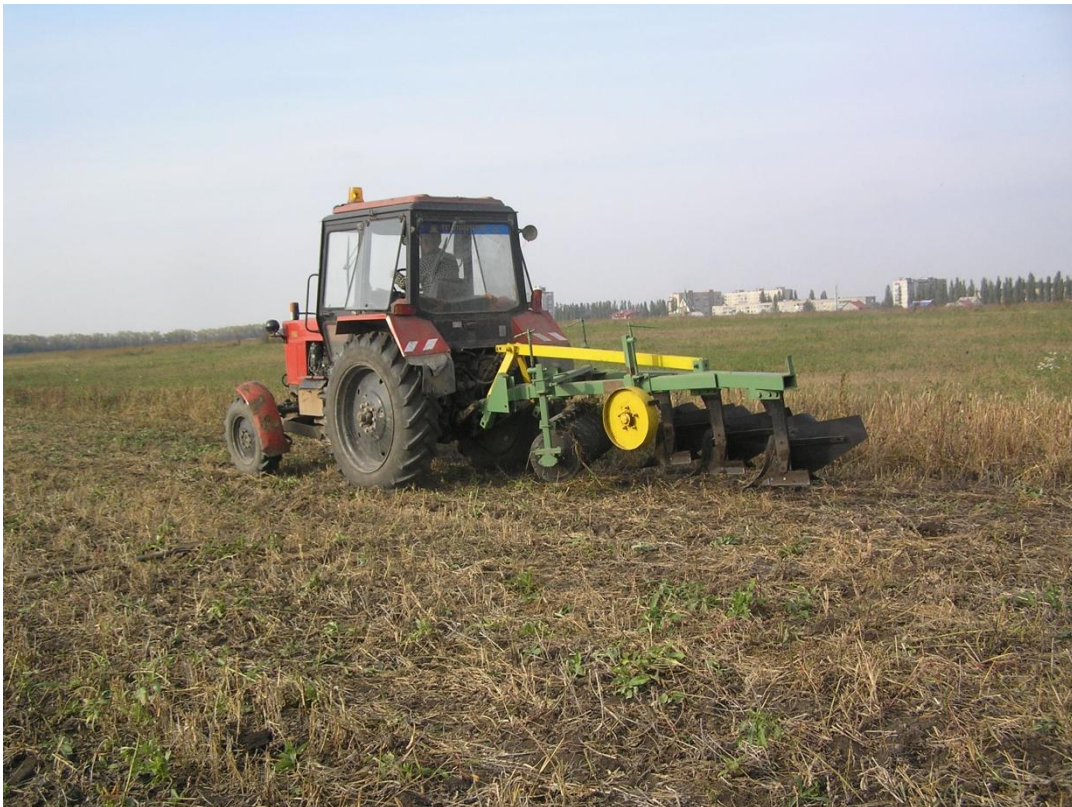
Рис. 2.28 – Трактор МТЗ-82 з плугом та дисковим подрібнювачем під час проведення порівняльних випробувань
