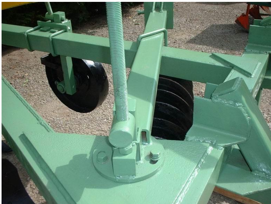
Рис. 2.18 – Регулювання кута атаки ( \alpha_d ) та висоти установки ( h_d ) дискового подрібнювача
