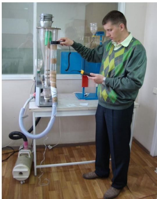
Рис. 3.20 – Вимірювання швидкості зависання фракцій яєць
