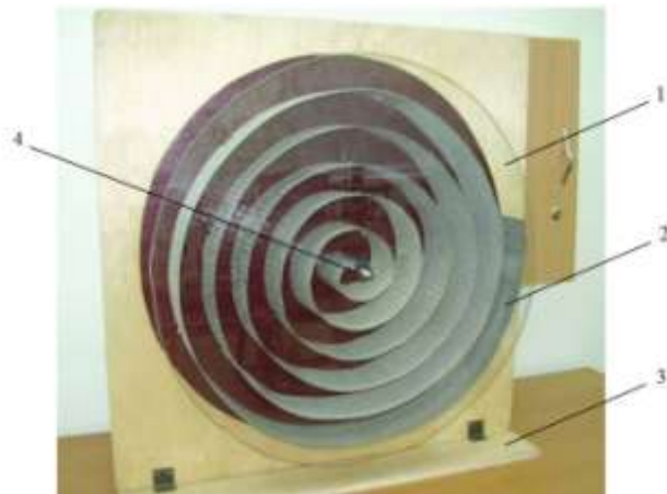
Рис. 4. Лабораторна установка для дослідження параметрів спіралеподібної перфорованої поверхні: 1 – оргскло; 2 – спіралеподібна перфорована поверхня; 3 – станина; 4 – привод обертання спіралеподібної перфорованої поверхні.
