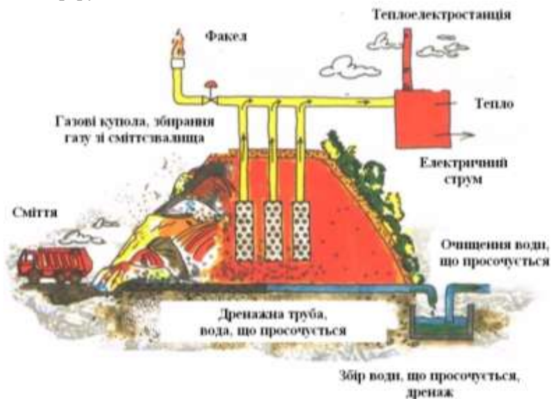
Рис.1. Отримання біогазу способом ферментації твердих відходів в умовах сміттєзвалища
