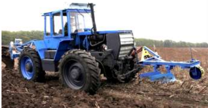
Рис. 1. Орний машинно-тракторний агрегат, що працює за схемою «push-pull» – «2+4»
