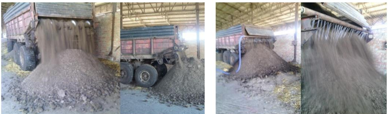
Рис. 2. Процес формування натурних буртів із використанням доопрацьованого розкидача органічних добрив ПРТ-10: а – без додаткового зволоження; б – із додатковим зволоженням
