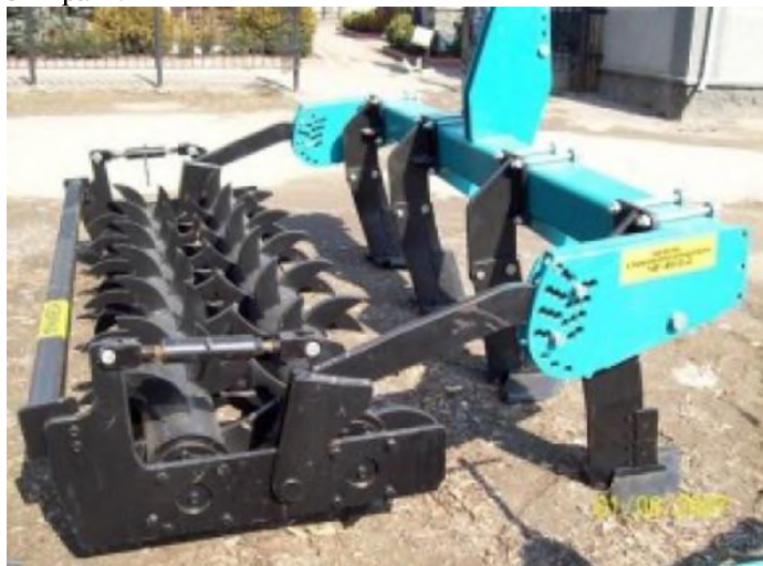
Рис. 2. Чизель ЧГ-40-02 з спеціальним котком виробництва Краснянський Агромаш (Україна).
