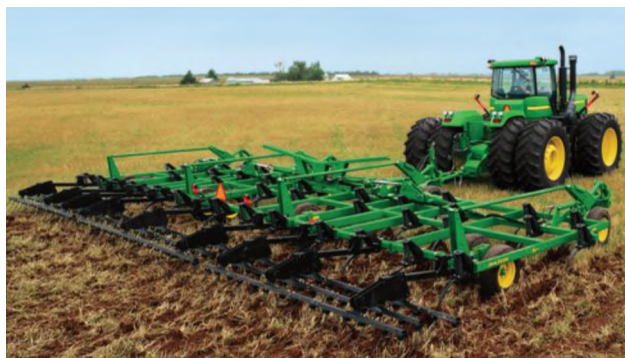
Рис. 1. Високопродуктивний чизель–ґрунтопоглиблювач моделі 2410 виробництва John Deere
