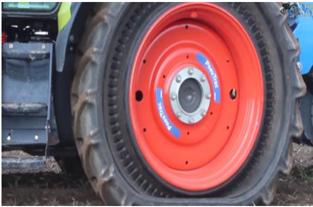
Рис. 3. Загальний вигляд та розподіл навантаження при використанні безкамерної шини PneuTrac
