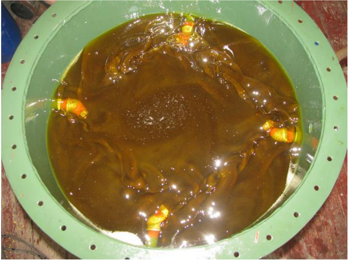
Рис. 3.2. Візуалізація інтенсивності перемішування емульсії при 200 об/хв (діаметр форсунок 7 мм, кут встановлення форсунок 45 град)
