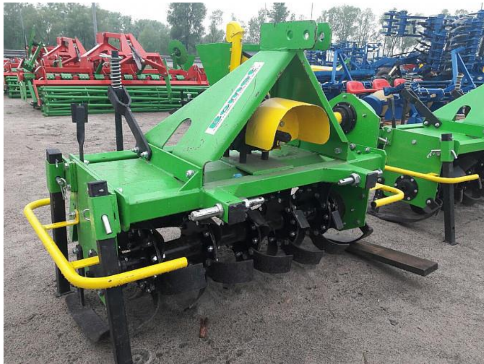
Рис. 1.1. Ґрунтообробне знаряддя з активними робочими органами (джерело фотографії: https://selo.ua/glevaxa/silgosptehnika/obrabotka-pochvy/freza-gruntoobrobna/pochvofreza-freza-gruntofreza-12-m-firmy-bomet-polsha-26299.html )
