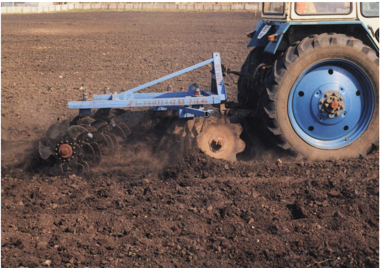
Рис. 3.1. Екологобезпечні робочі органи розміщені в другому ряді на ґрунтообробному знарядді (варіант 1)
