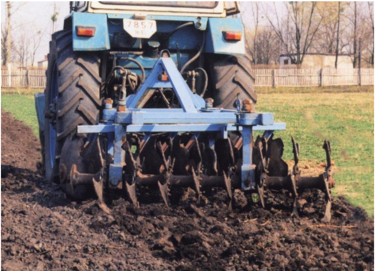
Рис. 2.1. Машинно-тракторний агрегат для проведення експериментальних досліджень ЮМЗ-6АЛ та дискової борони БДЛ-1,8
