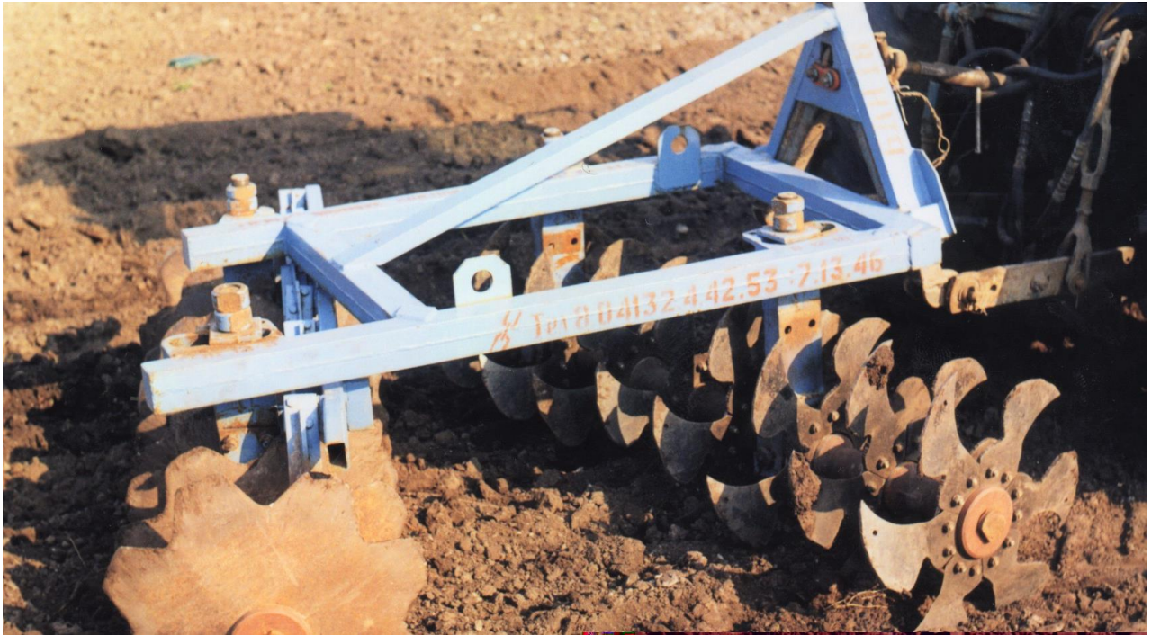
Рис. 3.2. Екологобезпечні робочі органи розміщені в першому ряді на ґрунтообробному знарядді (варіант 2)
