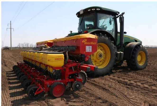
Рис. 1.2. Сівалка MS TWIN пневматичного типу для просапних культур для дворядкового посіву на базі стійки MS-8000
