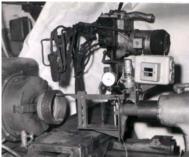
Рис. 2.4. Фрагмент наплавлювальної установки з пристосуванням для вимірювання деформаційних змін чавунних стаканів під час наплавлення та охолодження
