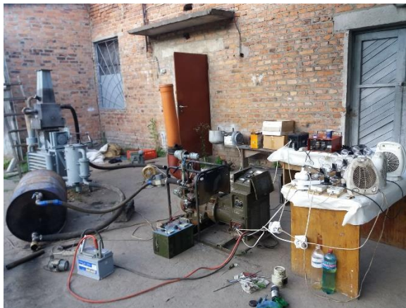
Рис. 2.1. Газогенераторна система конструкції Поліського національного університету [13]
