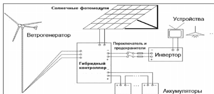
Рис. 5. Схематичне зображення режиму роботи гібридної автономної системи «сонце-вітер».
