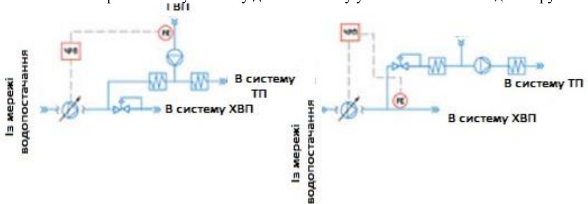
Рис. 2. Схема управління насосами з використанням ЧРП в системах ГВП та ТП
