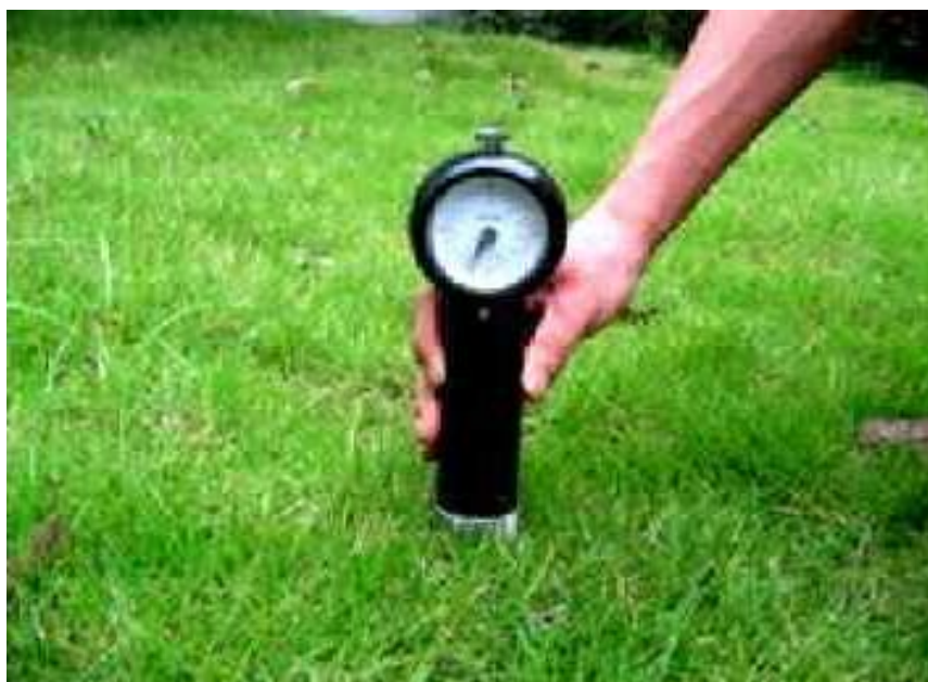
Рис.2.2. Визначення твердості ґрунту електронним твердоміром.
